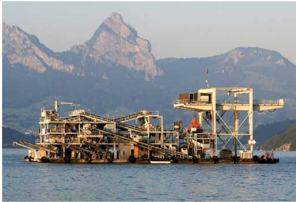
Europarekord: Am Vierwaldstätter See in der Schweiz ist ein Kröger-Seilgreifer im Einsatz, der 180 m tief baggert.
